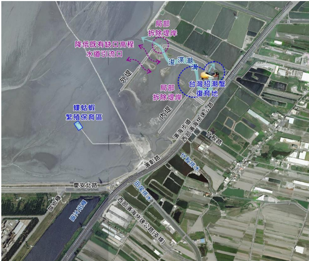
圖 8 海堤拆除完成後之配置圖
